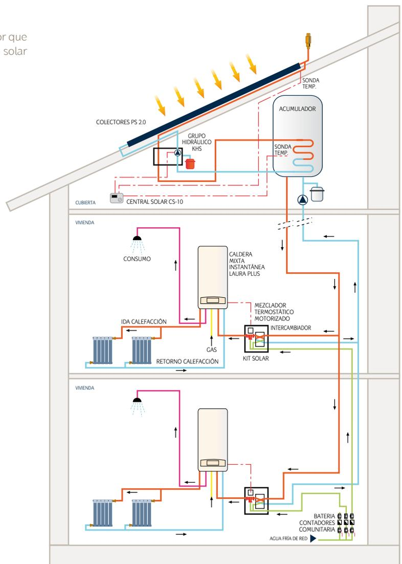
Ilustración básica de instalación.
