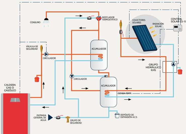
INSTALACIÓN COMPLETA PARA LA PRODUCCIÓN DE AGUA CALIENTE SANITARIA Y EL CALENTAMIENTO DE UNA PISCINA CUBIERTA / DESCUBIERTA.
